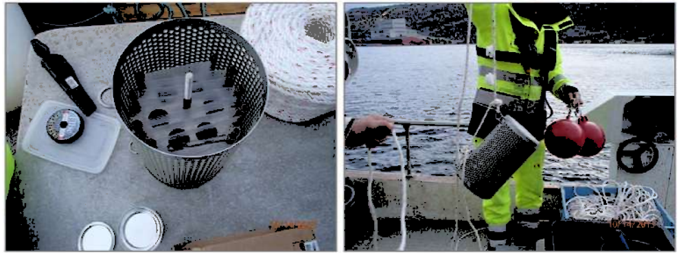
Figur 16 Oppsett for passive prøvetakere.
